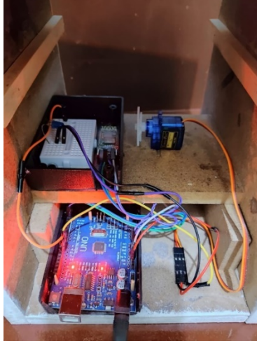
Görsel 7. Elektronik sistemin çekmeceli dolaba montajı
