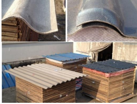
Görsel 8. Farklı malzemeler uygulanarak test edilen çatı örnekleri
