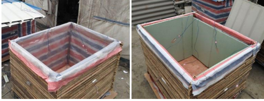
Görsel 7. Farklı yalıtım malzemeleri uygulanarak test edilen bambu barınak prototipleri
