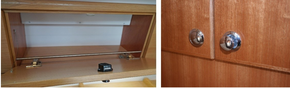
Görsel 10. Yatlarda raf tutucu ve kilitli kulp detayı
