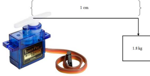
Görsel 5. Servo motor tork-ağırlık örneği
